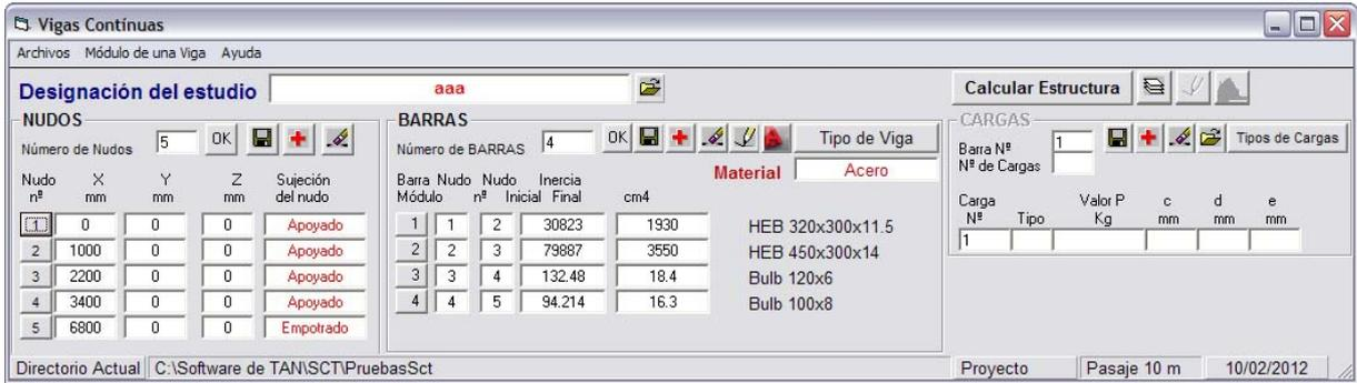
Se pueden plantear estructuras formadas por diversas vigas compuestas por cualquier tipo de perfil. Se calculan las reacciones en los diversos nudos y los momentos flectores y esfuerzos cortantes en cada viga.
