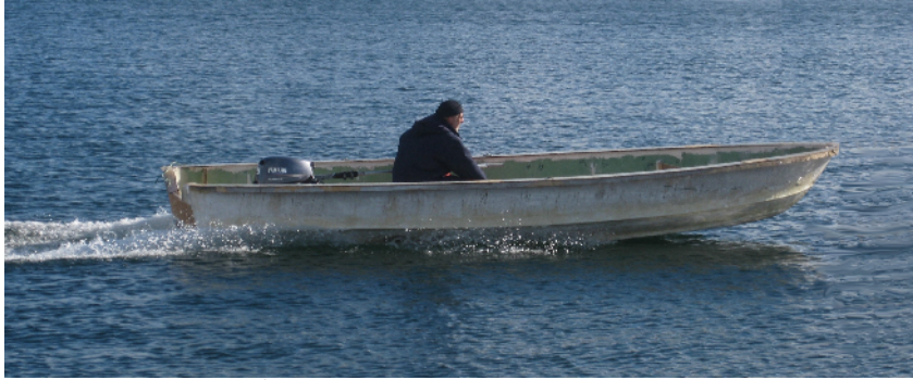
5,5 meters testbåt med akterskepps interceptor och indragen motor
