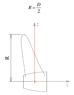
**Figure 40: Propeller radius**
