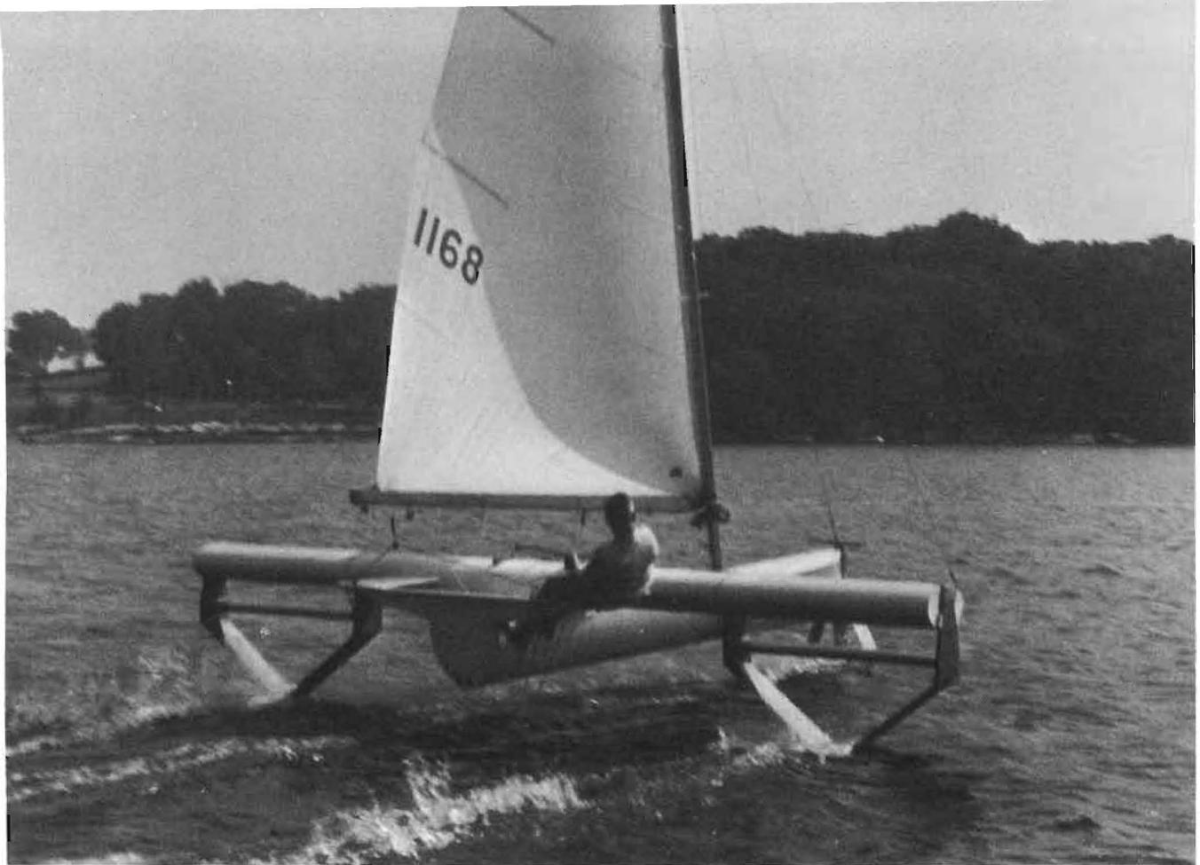
*Fig. 39 Nigg's Flying Fish foil-borne*
