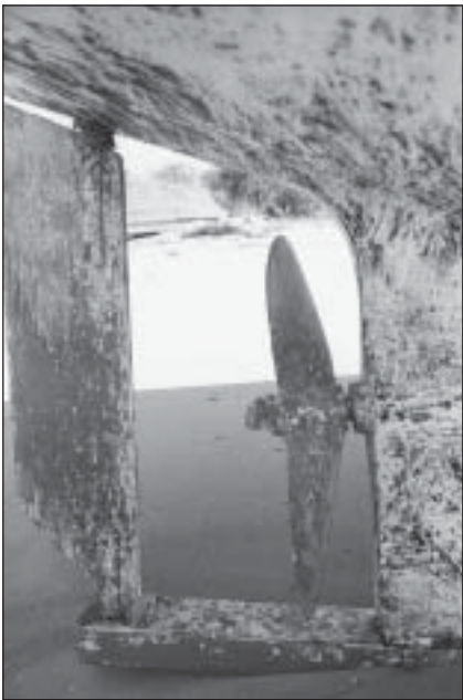
Photo 3 Dégagement insuffisant entre massif et hélice
