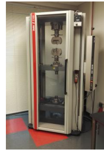
Fig. 1. Zwick & Roell Z100 tensile testing machine.
