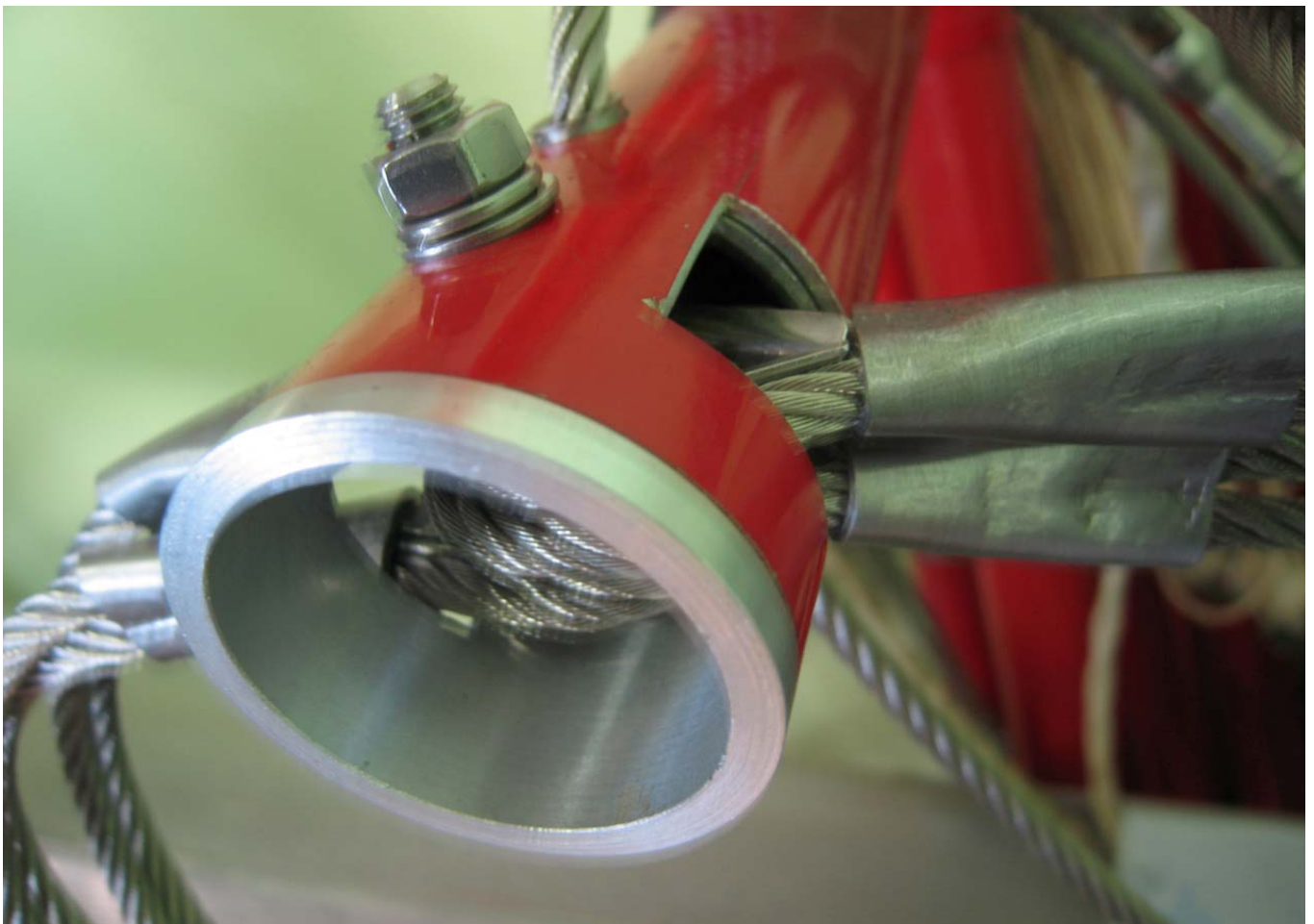
Крепление тросов в низу шпрюйта
