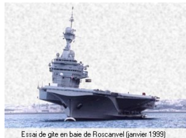
Essai de gîte en baie de Roscanvel (janvier 1999)
