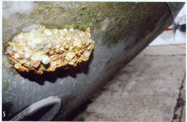
1 De test beginnen met een schone boot. 2 Klein beetje aanslag dankzij de goed werkende gewone anti-fouling. 3 Na een jaar Bright Spark zichtbaar schoon. 4 Maurice Tax laat zien hoe gering de aangroei is. 5 De anode heeft wél aangroei.
