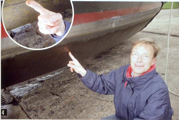
1 De test beginnen met een schone boot. 2 Klein beetje aanslag dankzij de goed werkende gewone anti-fouling. 3 Na een jaar Bright Spark zichtbaar schoon. 4 Maurice Tax laat zien hoe gering de aangroei is. 5 De anode heeft wél aangroei.
